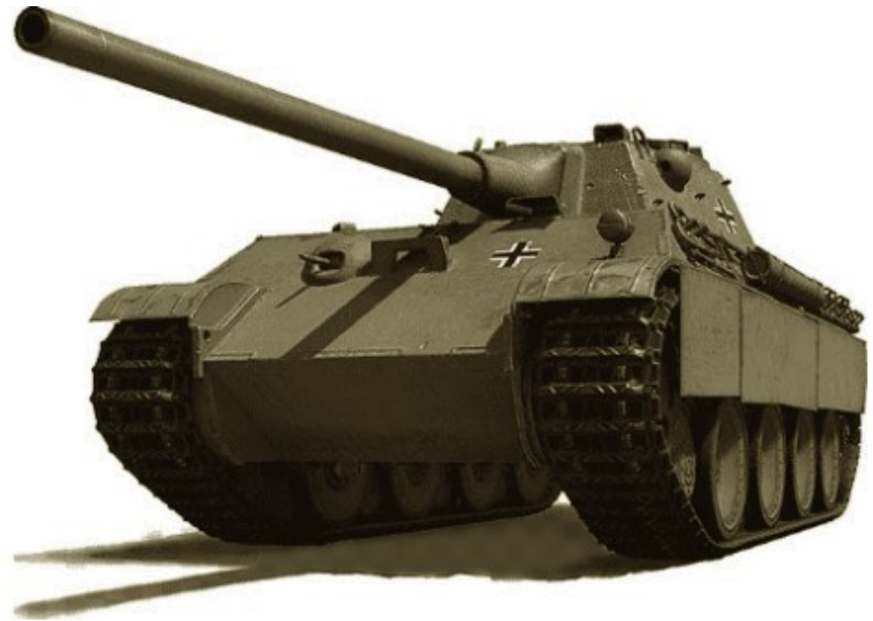
PANTHER : 280 l/100 km sur route*, autonomie 250 km. 46 tonnes, 5 508 exemplaires fabriqués.
