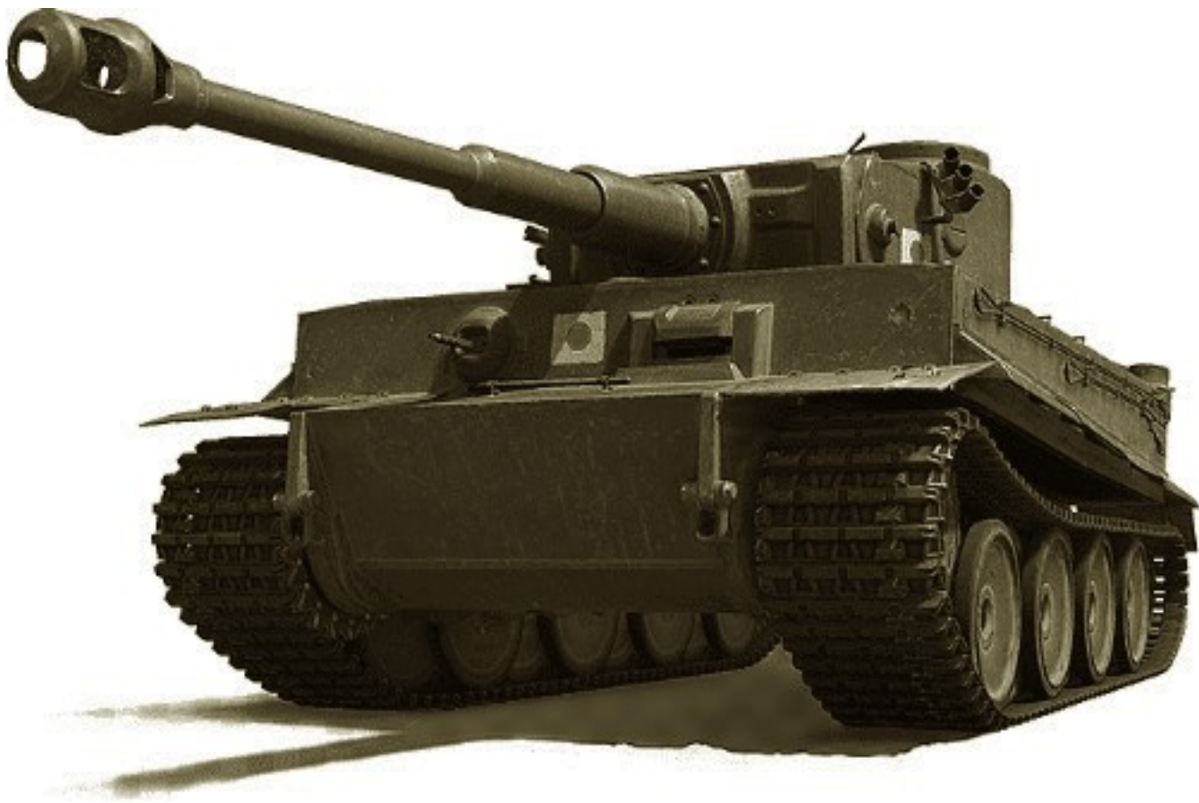
TIGRE 1 : 487 l/100 km sur route*, autonomie 125 km. 57 tonnes, 1 354 exemplaires fabriqués.
